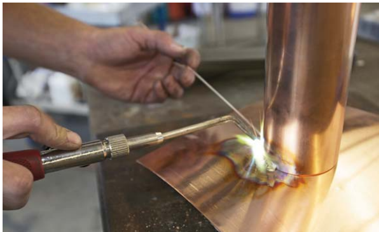
Soldadura de cobre
