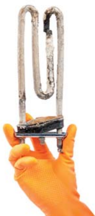
Avería parcial de una lavadora por calcificación de la resistencia de caldeo
