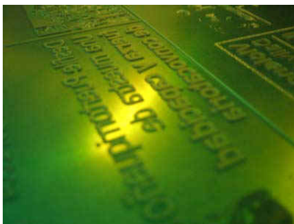
Plancha flexográfica preparada para impresión
