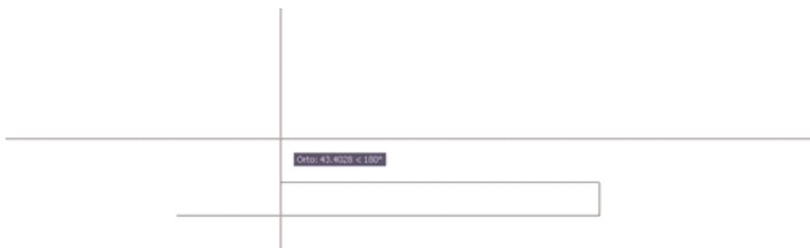
Una vez creado este dibujo, trazaremos una línea en la parte izquierda del rectángulo. Ésta tendrá la misma distancia del lado menor del rectángulo, 4.50m.
